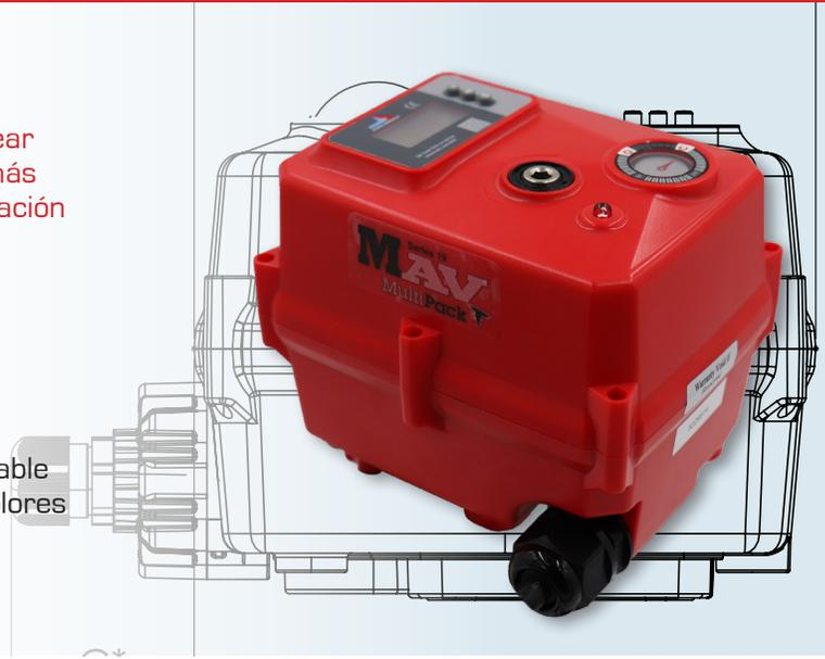
El actuador a prueba de fallas funciona mientras se cargan los capacitores internos. Cuando hay un corte en la energía eléctrica, los condensadores se descargan y alimentan la unidad a una posición de predeterminedada. Cuando se restablece la energía, los condensadores se cargan nuevamente. Para obtener diagramas de cableado y otros documentos técnicos, visite nuestro sitio web.
