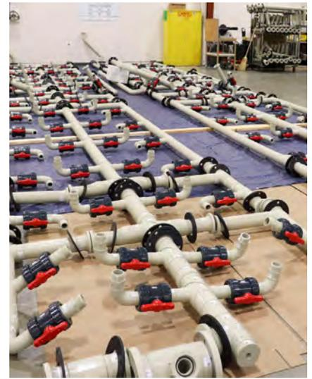
*Ejemplo de un skid de ultrafiltración que se instalará en un remolque*
