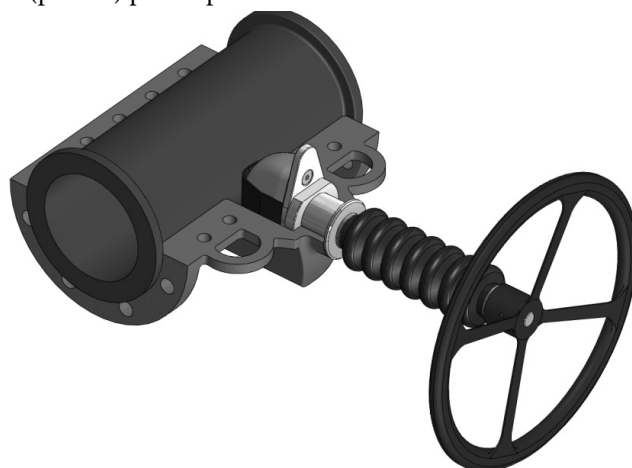
Figura 8. Retirada de las piezas del cuerpo de la válvula.
