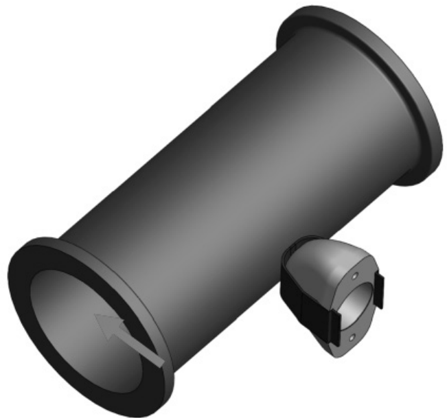
Figura 12. Instalación del manguito en el empujador.
