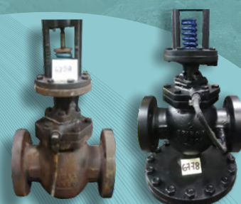
Válvulas reductora de presión
