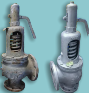
Válvulas de seguridad o alivio
