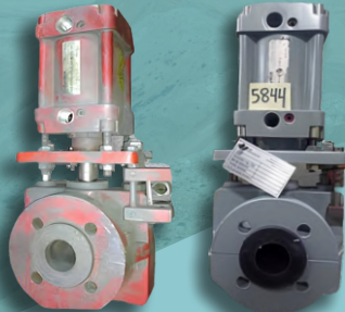
Válvulas pinch en línea con actuador neumático, manual o hidráulico
